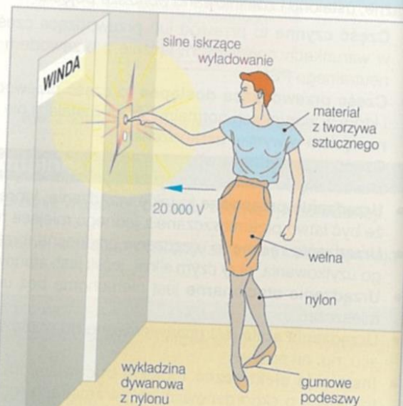
Rys. 3. Elektrostatyczne ładunki i iskrzenie przy rozładowaniu
