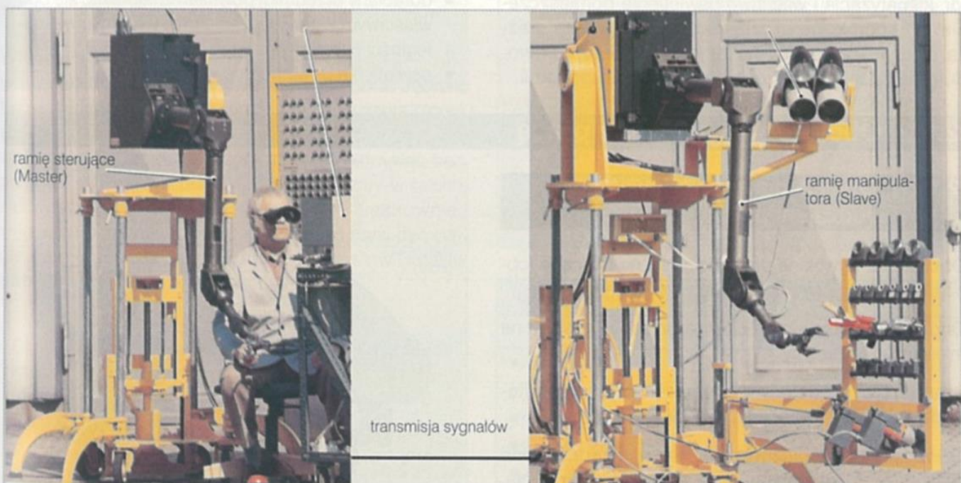
Rys. 3. Telemanipulator sterowany na podstawie przestrzennego (3D) obrazu wizyjnego
