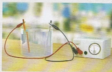
Rys. 10.1. Schemat budowy ogniwa Volty.
